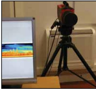
de cámara cubre un amplio abanico de aplicaciones en laboratorio de caracterización de materiales o diagnóstico de diversas patologías médicas (daños vasculares, cáncer, daños musculoesqueléticos, etc.). Por otra parte, al tener una alta velocidad de muestreo, permite el análisis térmico de diversos procesos en la industria de materiales, biomecánica, automoción, etc. Su alta sensibilidad permite distinguir además mínimas variaciones de temperatura en puntos próximos.
