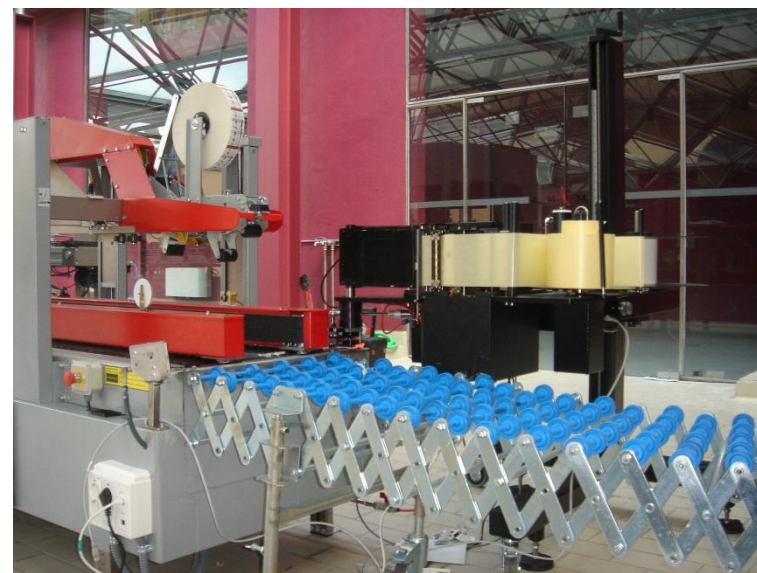
Aplicación de etiquetas en cajas con numeración unitaria (EAN 128) + generación etiqueta palet.
